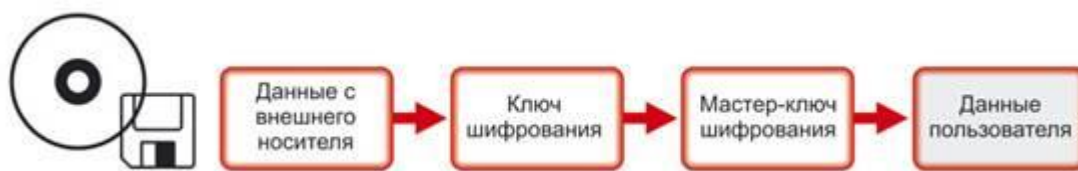
СХЕМА №2. ШИФРОВАНИЕ МАСТЕР-КЛЮЧА С ИСПОЛЬЗОВАНИЕМ ДАННЫХ С ВНЕШНЕГО НОСИТЕЛЯ (ДИСКЕТА, CD-ДИСК).
