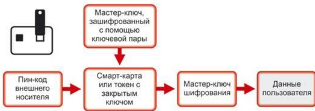
СХЕМА №5. ШИФРОВАНИЕ МАСТЕР-КЛЮЧА С ИСПОЛЬЗОВАНИЕМ АСИММЕТРИЧНОГО АЛГОРИТМА ШИФРОВАНИЯ.
