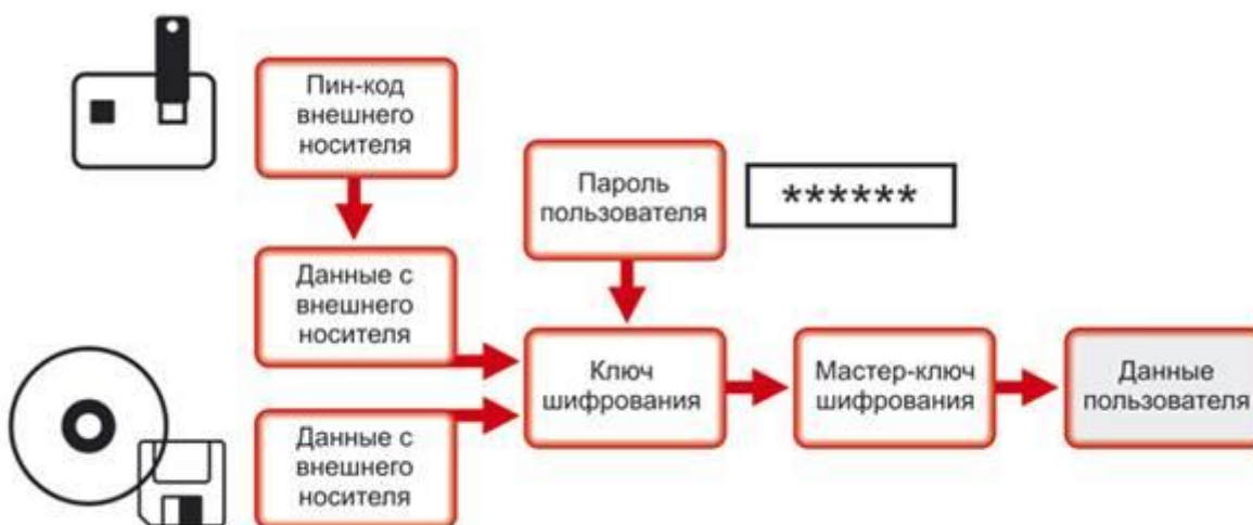
СХЕМА №4. ШИФРОВАНИЕ МАСТЕР-КЛЮЧА С ИСПОЛЬЗОВАНИЕМ НЕСКОЛЬКИХ КОМПОНЕНТОВ.
