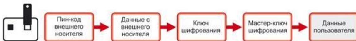
СХЕМА №3. ШИФРОВАНИЕ МАСТЕР-КЛЮЧА С ИСПОЛЬЗОВАНИЕМ ЗАЩИЩЕННОГО ВНЕШНЕГО НОСИТЕЛЯ (ТОКЕН, СМАРТ-КАРТА).
