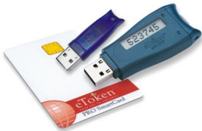
РИС.1. ТОКЕНЫ ДЛЯ АУТЕНТИФИКАЦИИ ПОЛЬЗОВАТЕЛЕЙ И НАДЕЖНОГО ХРАНЕНИЯ ЗАКРЫТЫХ КЛЮЧЕЙ ЭЦП.
